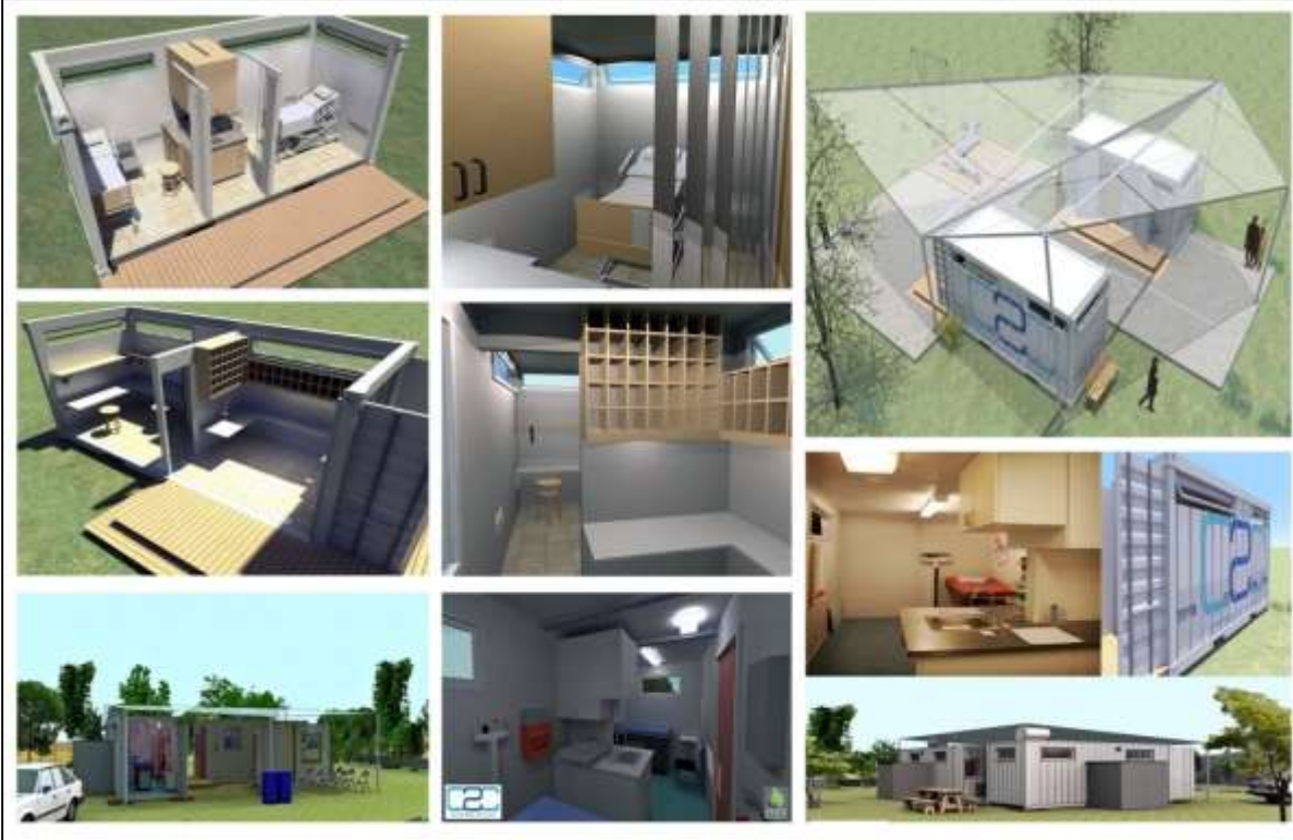
شكل ( 12 ) لقطات تظهر طرق تركيب و تجميع الوحدات العلاجية المصممة من حاويات الشحن السابقة الاستخدام مع عمل تغطية جمالوني الشكل.
