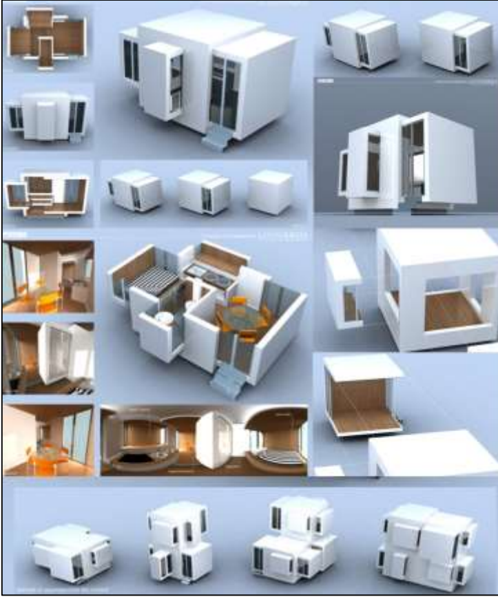
شكل (4) لحيز هندسي مركب Compound Spaces وحدة مكعبة الشكل يمكن تكرارها بصورة متتالية لوحدة الطوارئ.
